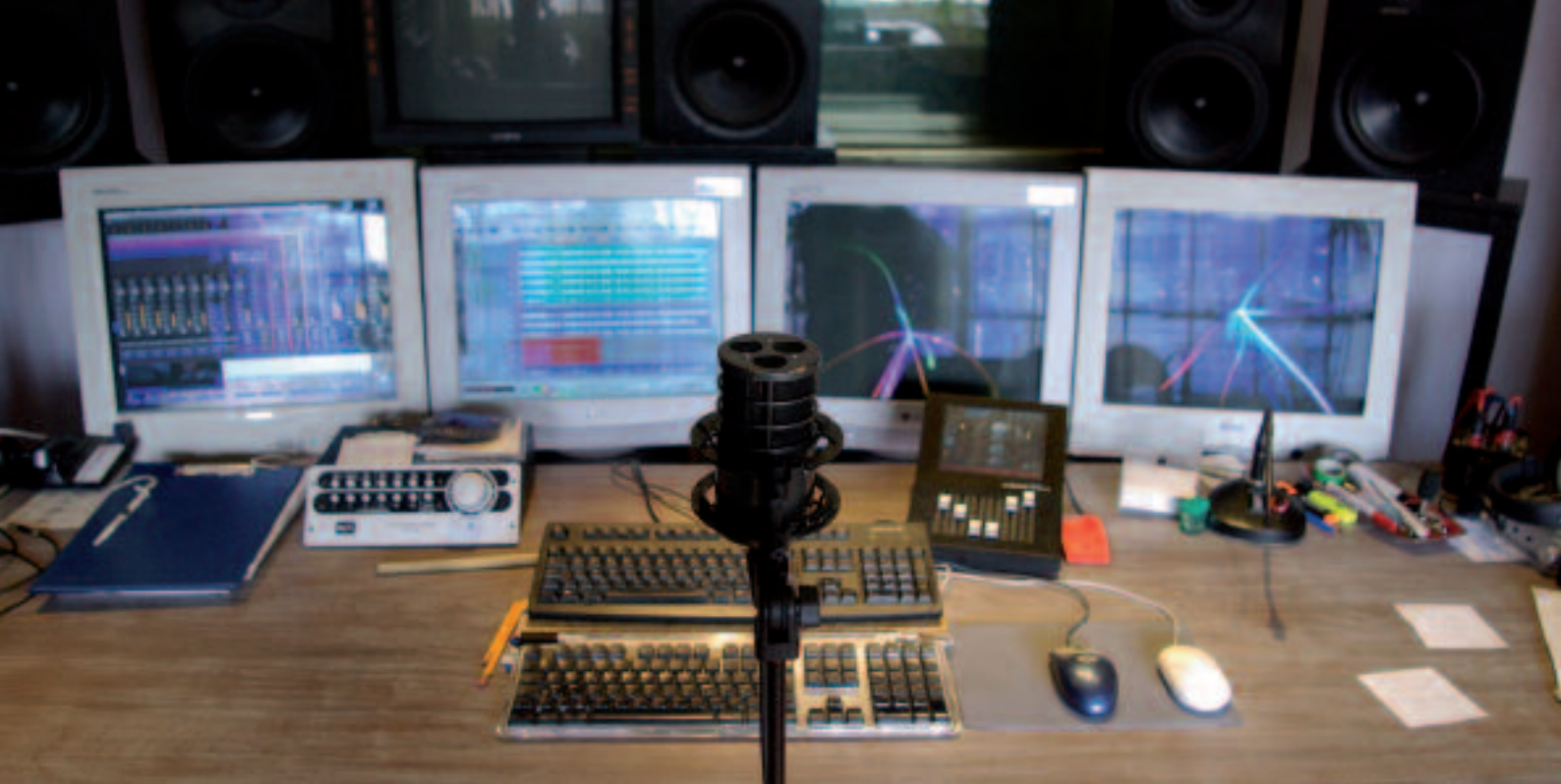
Drei Kapseln, im Winkel von 120 Grad zueinander angeordnet, genügen, um 6.0-Surroundsound zu erzeugen. Der Klang ist hervorragend und für alle sechs Kanäle identisch.
