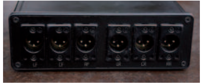
Rückseitig befinden sich die XLR-Anschlüsse für alle sechs Surround-Ausgänge.
