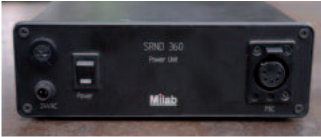
Netzanschluss und eine Multipin-XLR-Buchse als Mikrofoneingang sind auf der Vorderseite der Power-Unit lokalisiert.
